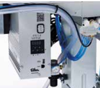
Caja de control
